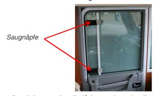
6- Das Produkt an der Beifahrerseite abrollen und mit Hilfe der – serienmäßig mitgelieferten – vier Druckknöpfe zum Anschrauben befestigen, <u>oder</u> optional mit vier Klebesockeln.
